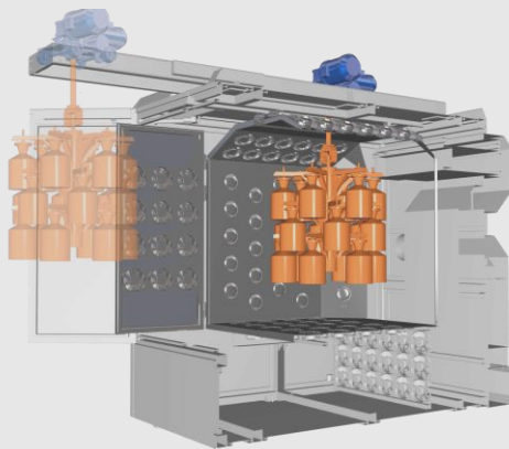
Установки для сушки керамических форм
